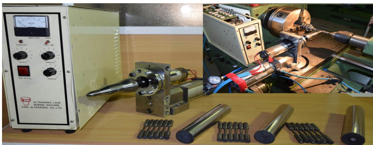
شکل (۲): نمونه‌های تست خستگی و ریزسختی‌سنجی، به‌همراه سامانه ارتعاشی UASR.
